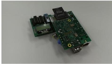
**Figure 12. New JAUS protocol converter**
